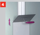
4 Vėliau užtepkite dar vieną glaisto arba paruošto mišinio sluoksnį, tik 50–60 mm platesnį nei pati siūlė. Laukite, kol sukibs ir išdžius.
